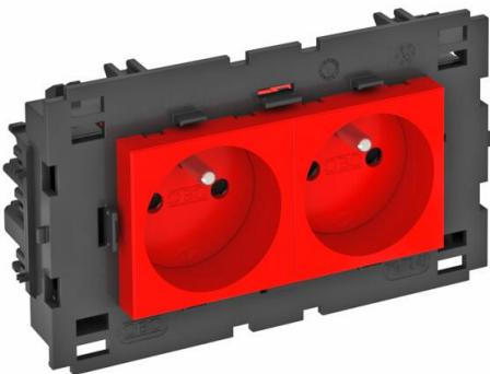
Prise de courant avec fiche de terre à raccordement latéral double 0°, avec protection renforcée contre les contacts accidentels, avec bornes à fiche, 2 pôles, 16 A, 250 V~, avec bornes de raccordement selon CEI 60884-1, convient pour le montage dans les systèmes de canaux d'allège Rapid 80. Pour l'installation dans des goulottes Rapid 45, des canaux d'allège, des colonnes de distribution, des systèmes sous chape et des boîtiers Deskbox.
