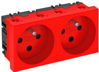
Prise avec fiche de terre, double, version codée, avec protection accrue contre les contacts, avec bornes enfichables, 2 pôles, 16 A, 250 V ~, avec bornes de raccordement selon CEI 60884-1.
