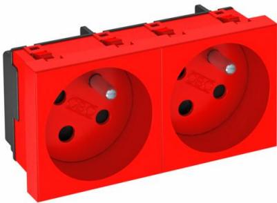
Prise de courant avec fiche de terre double 33°, version codée, avec protection renforcée contre les contacts accidentels, avec bornes à fiche, 2 pôles, 16 A, 250 V~, avec bornes de raccordement selon CEI 60884-1.
