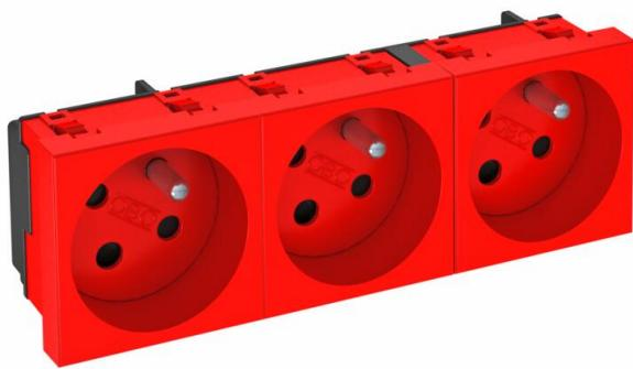
Prise de courant avec fiche de terre triple 33°, version codée, avec protection renforcée contre les contacts accidentels, avec bornes à fiche, 2 pôles, 16 A, 250 V~, avec bornes de raccordement selon CEI 60884-1.
