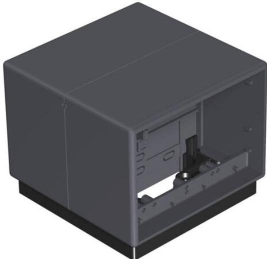
Pour le montage combiné de 4 appareillages simples avec cadre (4 appareillages d'une nature de courant ou 2 fois 2 appareillages de deux natures de courant). Les différentes natures de courant sont isolées l'une de l'autre par une cloison de séparation. Modes de fixation par vis pour appareillages : 60 mm à la verticale.
