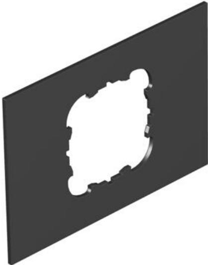
Plaque de support d'appareillages avec 1 perçage ( $\varnothing$  45 mm) pour un appareillage d'installation avec support à griffe, adaptée au côté longitudinal T4B (couvercle 1/1).
