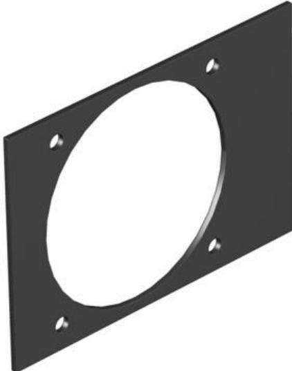
Plaque de support d'appareillages avec 1 perçage ( $\varnothing$  70 mm) et fixation par vis 60 x 60 mm pour prises CEE, adaptée au côté longitudinal T4B (couvercle 1/1).
