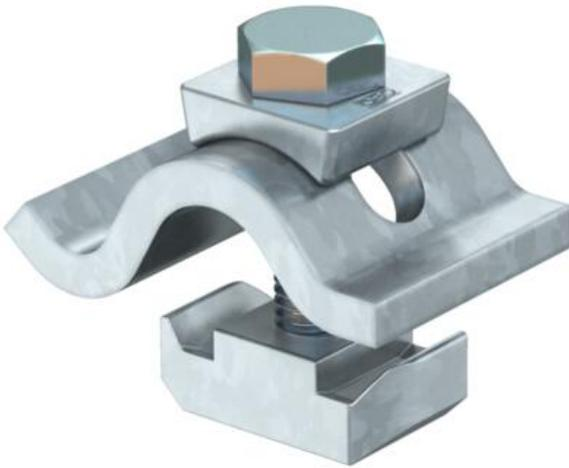
Crampon de serrage avec écrou-coulisseau pour la fixation des rails profilés sur poutres métalliques (IPN).
