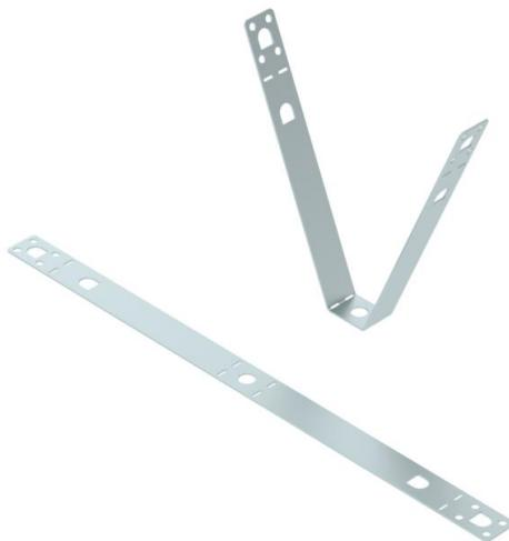
Trapèze de fixation pour la suspension de système de support de câbles sur plafond trapézoïdal standard. Largeur de profilé trapézoïdal jusqu'à 165 mm. Montage avec verrou de blocage type TPB R ou vis à tête hexagonale type SKS 10x110. Le matériel de fixation doit être commandé séparément.
