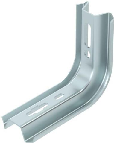
Pendarde/console TP à fixer sur les plafonds en béton horizontaux et aux murs. Si le profil est fixé au plafond ou si le profil est vissé l'un contre l'autre pour renforcer la tête, l'entretoise type DS 4 doit toujours être utilisée pour des raisons de stabilité.
