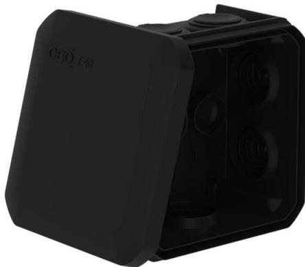
Boîte de dérivation pour le raccordement des câbles et conduits en intérieur et en extérieurs protégés. Forme carrée avec des joints d'étanchéité sur les côtés et des entrées défonçables dans le fond. Convient pour le montage au mur / au plafond et sur des tôles de montage. Avec possibilité de fixation intérieure. Avec couvercle à encliqueter. Fabriqué à partir de matériaux sans halogène et résistants aux UV.
