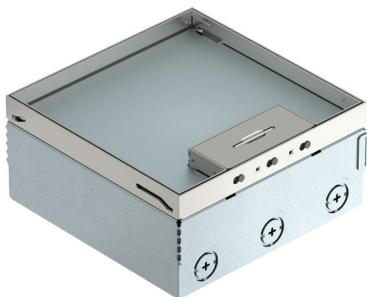
Boîtier de sol carré pour une utilisation dans des planchers creux et des chapes nettoyés à sec, utilisation à l'intérieur. Boîtier de montage avec ouvertures d'insertion pré découpées pour canalisations (M25). Couvercle réglable sur le rebord supérieur du revêtement de sol à l'aide de 4 supports de nivellement. Evidemment dans le couvercle rabattable 15 mm. La profondeur d'encastrement minimale est de 95 mm, la plage de réglage + 30 mm.
