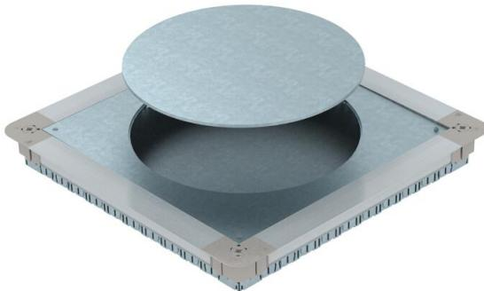
Boîte d'appareillage sous plancher avec couvercle de montage et plaque borgne, avec parois latérales en tôle d'acier. Pour le montage d'un boîtier de sol carré GES9 55 dans des hauteurs de chape à partir de 55 mm. Possibilité de nivellement continu à hauteur de la chape et la chape peut être coulée de manière affleurante à l'arête de retraite de la chape. Avec ouvertures d'entrée de tubes sur chaque côté 7 x M20, 3 x M25, 4 x M32. Taille de tubes utile pour la hauteur système de 55 mm : M20.
