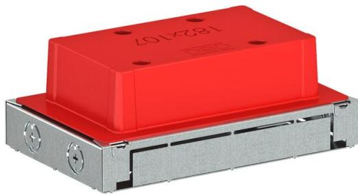
Boîte de raccordement sous plancher avec ouverture de montage fixe et non modifiable de 106 x 182 mm pour une unité d'installation de taille nominale 2. L'ouverture de montage est réalisée à l'aide d'un élément de coffrage compris dans la livraison. La boîte sous plancher présente sur la face avant des ouvertures de montage pour deux tuyaux d'installation M20 chacun. La boîte s'utilise principalement dans des planchers constitués d'une chape en ciment, d'une hauteur de montage de 70 à 90 mm.
