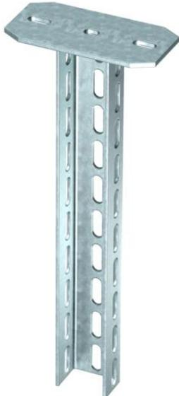
pendard (profilé en U) de dimensions 70 x 50 mm avec plaque de tête soudée. Pour la fixation au plafonds en béton horizontaux et poutres métalliques horizontales. A partir d'une largeur de support de 400 mm ou lorsque le support est installé à l'extrême du support suspendu, l'utilisation de l'entretoise de type DSK 61 est recommandée
