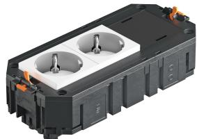
Le support universel prêt à raccorder UTC3 dispose de deux prises de contact de protection à 33° préinstallées et d'un couvercle borgne pour le montage ultérieur d'un dispositif d'installation de la série Modul 45 ou Modul 45connect. Convient pour les câbles de raccordement VL et les unités de montage d'appareils de taille nominale 2, 4, R4, 6 et R7.
