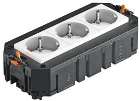
Le support universel prêt à raccorder UTC3 dispose de trois prises à contact de protection à 33° préinstallées avec 16 A. Convient pour les câbles de raccordement VL et les unités de montage de taille nominale 2, 4, R4, 6 et R7.
