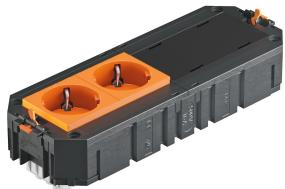
Le support universel prêt à raccorder UTC4 dispose de deux prises de contact de protection à 33° préinstallées avec 16 A et d'un couvercle borgne pour le montage ultérieur de deux appareillages d'installation individuelle de la série Modul45 ou Modul45connect. Convient pour les câbles de raccordement VL et pour l'utilisation dans les unités de montage d'appareils de taille nominale R7, R9 et 9.
