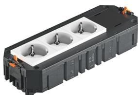
Le support universel prêt à raccorder UTC4 dispose de trois prises de contact de protection à 33° préinstallées avec 16 A et d'un couvercle borgne pour le montage ultérieur d'un dispositif d'installation de la série Modul 45 ou Modul 45connect. Convient pour les câbles de raccordement VL et pour l'utilisation dans les unités de montage d'appareils de taille nominale R7, R9 et 9.
