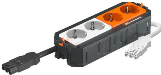
Le support universel prêt à connecter UTC4 dispose de 2 prises de contact de protection 33 ° préinstallées en blanc et de 2 prises de contact de protection 33 ° préinstallées en orange (avec module de protection contre les surtensions type 3 selon DIN EN 61643-11), 250 V ~ 16 A. Convient pour les câbles de raccordement VL et les unités d'installation d'appareil de taille nominale R7, R9 et 9.
