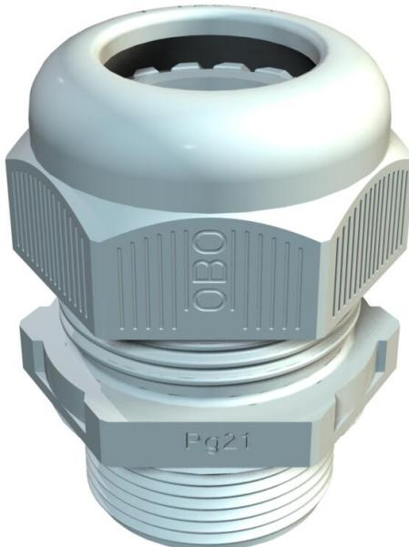
Presse-étoupe avec raccord fileté PF de type écrou borgne, pour boîtes de dérivation, boîte, coffret de distribution dans le domaine privé et industriel. Avec décharge de traction et lèvre d'étanchéité intégrée, testé selon la norme DIN EN 62444. Indice de protection IP68. Utilisation possible de -20 °C à +65 °C
