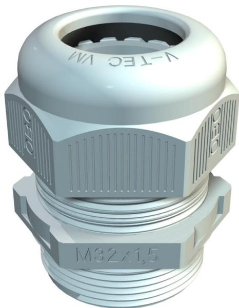
Presse-étoupe avec raccord fileté métrique de type écrou borgne, pour boîtes de dérivation, boîte, coffrets de distribution dans le domaine privé et industriel. Avec décharge de traction et lèvre d'étanchéité intégrée, testé selon la norme DIN EN 62444. Indice de protection IP68. Utilisation possible de -20 °C à +65 °C
