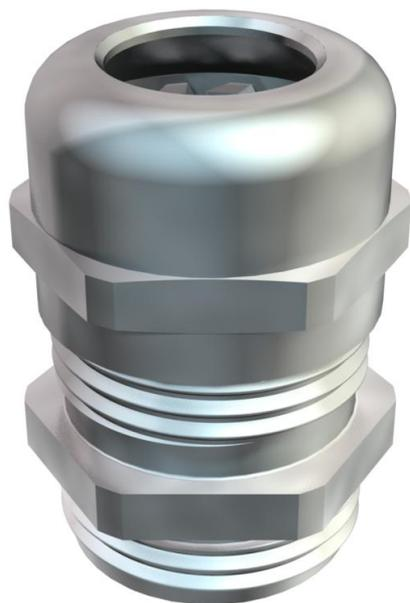
Presse-étoupe de type écrou borgne avec grande capacité d'étanchéité, avec décharge de traction et protection anti-torsion satisfaisant aux exigences élevées en matière d'étanchéité, avec raccord fileté PG selon DIN 40430. Insert de serrage en polyamide, bague d'étanchéité en caoutchouc chloroprène/nitrile, avec joint torique préassemblé sur le filetage de raccordement.
