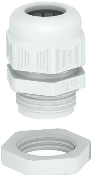
Presse-étoupe avec raccord fileté PF de type écrou borgne, pour boîtes de dérivation, boîte, coffret de distribution dans le domaine privé et industriel. Avec décharge de traction et lèvre d'étanchéité intégrée, testé selon la norme DIN EN 62444. Indice de protection IP68. Utilisation possible de -20 °C à +65 °C
