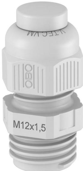
Presse-étoupe avec raccord fileté métrique de type écrou borgne, pour boîtes de dérivation, boîte, coffrets de distribution dans le domaine privé et industriel. Avec décharge de traction et lèvre d'étanchéité intégrée, testé selon la norme DIN EN 62444. Indice de protection IP68. Utilisation possible de -20 °C à +65 °C. Cela permet de fermer sans difficulté des ouvertures non utilisées. La poussière ou l'eau ne pouvant pénétrer, l'indice de protection est maintenu.
