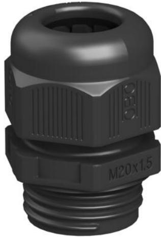
Presse-étoupe avec raccord fileté métrique de type écrou borgne, pour boîtes de dérivation, boîte, coffret de distribution dans le domaine privé et industriel. Avec décharge de traction et lèvre d'étanchéité intégrée, testé selon la norme DIN EN 62444. Indice de protection IP68. Utilisation possible de -20 °C à +65 °C
