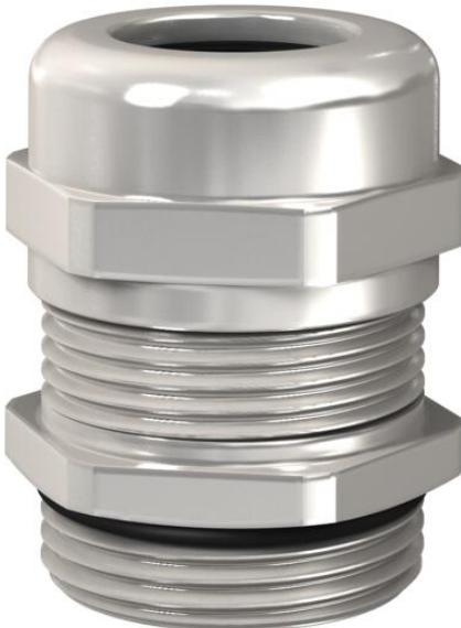
Presse-étoupe EMV robuste avec raccord fileté métrique selon la norme CEI 423, modèle avec écrou borgne pour des exigences d'étanchéité élevées. Décharge de traction, protection antitorsion et étanchéité pour l'ensemble de la plage de serrage. Bague d'étanchéité en néoprène. Insert de serrage en polyamide. Avec joint torique prémontée sur le raccord fileté, testé VDE selon la norme DIN EN 50262, indice de protection IP 68 à 5 bars / 1 h, .
