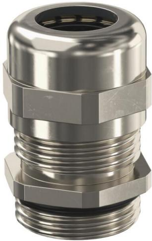
Presse-étoupe robuste de type écrou borgne avec filetage métrique selon la norme CEI 423, pour des exigences d'étanchéité élevées. Décharge de traction, protection antitorsion et étanchéité pour l'ensemble de la plage de serrage. Bague d'étanchéité en néoprène. Garniture de serrage en polyamide. Avec bague d'étanchéité prémontée sur le raccord fileté, testé VDE selon la norme DIN EN 50262, indice de protection IP68 à 5 bar/1 h, plage de température de - 20 à 100 °C.
