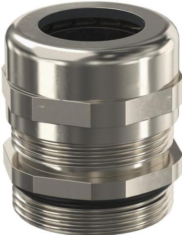
Presse-étoupe robuste de type écrou borgne avec filetage métrique selon la norme CEI 423, pour des exigences d'étanchéité élevées. Décharge de traction, protection antitorsion et étanchéité pour l'ensemble de la plage de serrage. Bague d'étanchéité en néoprène. Garniture de serrage en polyamide. Avec bague d'étanchéité prémontée sur le raccord fileté, testé VDE selon la norme DIN EN 50262, indice de protection IP68 à 5 bar/1 h, plage de température de -20 à 100 °C.
