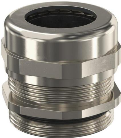
Presse-étoupe robuste de type écrou borgne avec filetage métrique selon la norme CEI 423, pour des exigences d'étanchéité élevées. Décharge de traction, protection antitorsion et étanchéité pour l'ensemble de la plage de serrage. Bague d'étanchéité en néoprène. Garniture de serrage en polyamide. Avec bague d'étanchéité prémontée sur le raccord fileté, testé VDE selon la norme DIN EN 50262, indice de protection IP68 à 5 bar/1 h, plage de température de - 20 à 100 °C.
