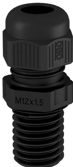
Presse-étoupe avec raccord fileté métrique de type écrou borgne, pour boîtes de dérivation, boîte, coffrets de distribution dans le domaine privé et industriel. Avec décharge de traction et lèvre d'étanchéité intégrée, testé selon la norme DIN EN 62444. Indice de protection IP68. Utilisation possible de -20 °C à +65 °C
