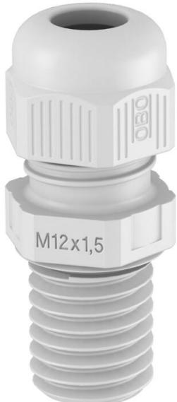
Presse-étoupe avec raccord fileté métrique de type écrou borgne, pour boîtes de dérivation, boîte, coffrets de distribution dans le domaine privé et industriel. Avec décharge de traction et lèvre d'étanchéité intégrée, testé selon la norme DIN EN 62444. Indice de protection IP68. Utilisation possible de -20 °C à +65 °C
