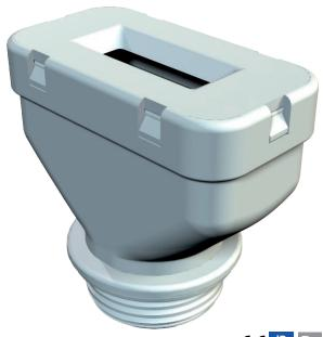
Entrée avec raccord d'étranglement pour câbles plats, avec filetage PG selon la norme DIN 40430, indice de protection IP 31, avec bague d'étanchéité pré-montée de type 107/F.
