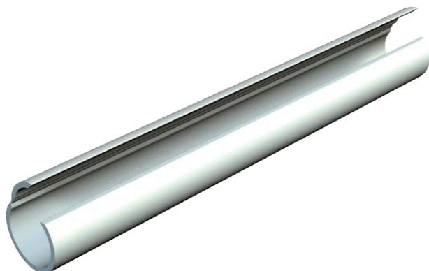
Quick-Pipe combine les avantages des goulottes de câblage et des tubes d'installation pour créer un système intelligent. Sur les murs et plafonds, ce système permet une installation en saillie soignée et sécurisée de différents câbles. Quick-Pipe est disponible en quatre dimensions métriques : M16, M20, M25 et M32 et est livré en longueur de 2 m.
