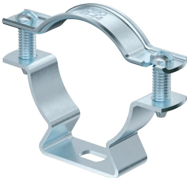
Collier d'écartement pour le montage de tubes et câbles au mur, au plafond et au sol. Avec partie supérieure autobloquante. Fixation par trou oblong. À partir de la taille 20 des colliers, convenant au montage avec cloueur ou pistolet de scellement.
