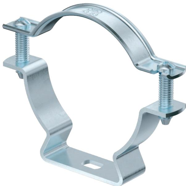
Collier d'écartement pour le montage de tubes et câbles au mur, au plafond et au sol. Avec partie supérieure autobloquante. Fixation par trou oblong. À partir de la taille 20 des colliers, convenant au montage avec cloueur ou pistolet de scellement.
