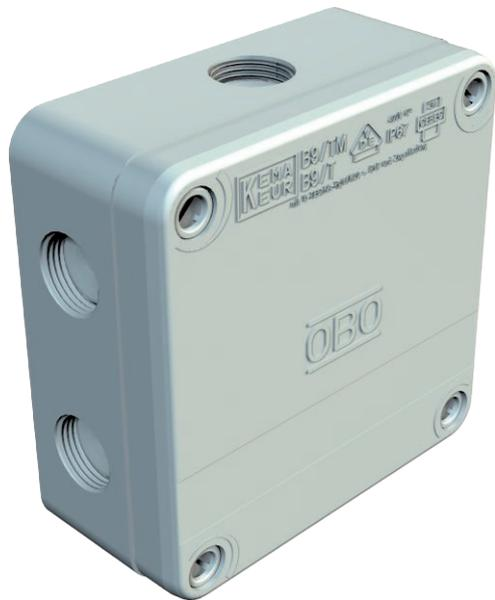
B9/T... : comporte deux composants différents en plastique, sans halogène, 8 entrées filetées (PG16) avec membrane défonçable (pour les diamètres de câble jusqu'à 15 mm) au niveau du fond. En cas d'utilisation des presse-étoupes (décharge de traction supplémentaire), il n'est pas nécessaire de retirer la membrane (gain de temps). Indice de protection IP 67 avec membrane défonçable et avec presse-étoupe sans retrait de la membrane défonçable.
