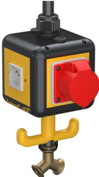
Boîtier équipé et précâblé avec 1 m de tuyau 1/2" et raccordement pour flexible d'air comprimé 13 x 3,5 mm et distributeur 2 voies 1/2", avec oeillets de suspension, poignée crochet et 4 plaques de recouvrement.
