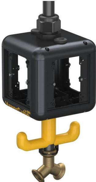
Boîtier vide avec 1 m de tuyau 1/2" et raccordement pour flexible d'air comprimé 13 x 3,5 mm et distributeur 2 voies 1/2". Avec oeillets de suspension et poignée crochet, pour montage de 4 appareillages électriques, avec cloison de séparation jointe. Sans plaque de recouvrement.
