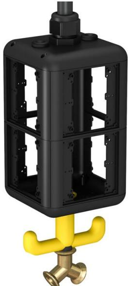
Boîtier vide avec 1 m de tuyau 1/2" et raccordement pour flexible d'air comprimé 13 x 3,5 mm et distributeur 2 voies 1/2". Avec oeillets de suspension et poignée crochet, pour montage d'appareillages électriques, avec cloison de séparation jointe. Sans plaque de recouvrement.
