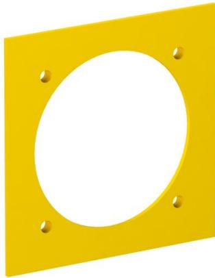
Plaque de recouvrement avec une ouverture de 70 mm de diamètre pour le montage d'une prise CEE 16/32 A avec entre-axe de 60 mm, 4 vis de fixation incluses.
