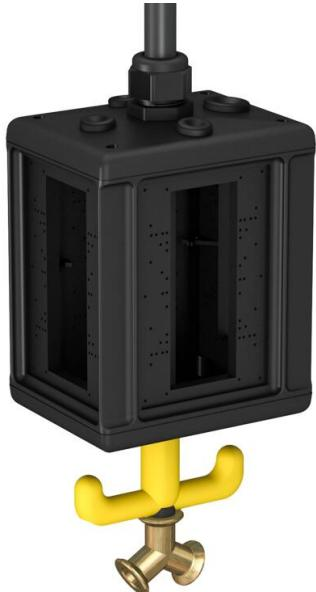
Boîtier vide avec 1 m de tuyau 1/2" et raccordement pour flexible d'air comprimé 13 x 3,5 mm et distributeur 2 voies 1/2". Avec oeillets de suspension et poignée crochet, pour montage d'appareillages électriques, avec cloison de séparation jointe. Sans plaque de recouvrement. Pour l'alimentation de postes de travail en milieux humides. Indice de protection : IP 44.
