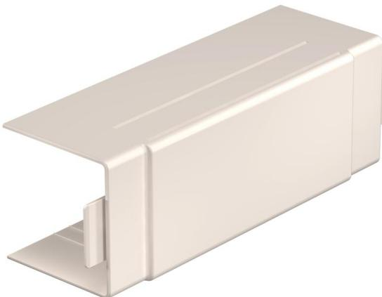
Pièces en Té et en croix pour changer la direction des goulettes WDK. La pièce de forme est pré-perforée sur le côté pour relier différentes sections de goulotte.
