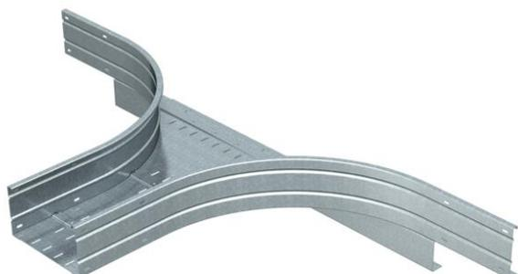
Dérivation à monter pour installation horizontale. Pour tous les chemins de câbles longue portée d'une hauteur latérale de 160 mm. Nous recommandons de prévoir des supports supplémentaires au niveau des pièces de forme pour une plus grande stabilité.
