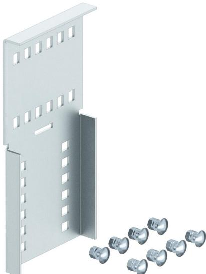
Éclisse coudée pour relier des éléments verticaux et horizontaux de chemins de câbles et échelles de câbles longue portée d'une hauteur latérale de 110 mm. Matériel de fixation inclus.
