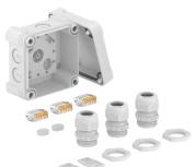
Boîtier de dérivation avec borne pour connecter des câbles et des conduites en intérieur et extérieur. Forme carrée avec entrées défonçables. Convient pour le montage au mur / au plafond avec possibilité de fixation extérieure, de fixation intérieure ou de montage sur les dômes d'angle. Particulièrement résistant aux chocs avec IK09 Couvercle avec fermeture rapide, plombable. Fabriqué à partir de matériaux sans halogène et résistant aux UV.
