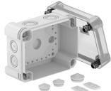
Boîtier de dérivation pour le raccordement de câbles et conduits en intérieur et en extérieurs protégés. Forme rectangulaire avec entrées défonçables. Convient pour le montage au mur / au plafond avec possibilité de fixation extérieure, de fixation intérieure ou de montage sur les dômes d'angle. Particulièrement résistant aux chocs avec IK09. Couvercle transparent avec fermeture rapide, plombable. Fabriqué à partir de matériaux sans halogène et résistant aux UV.
