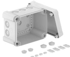
Boîtier de dérivation pour le raccordement de câbles et conduits en intérieur et en extérieurs protégés Forme rectangulaire avec entrées défonçables. Convient pour le montage au mur / au plafond avec possibilité de fixation extérieure, de fixation intérieure ou de montage sur les dômes d'angle. Particulièrement résistant aux chocs avec IK09 Couvercle avec fermeture rapide, plombable. Fabriqué à partir de matériaux sans halogène et résistant aux UV.
