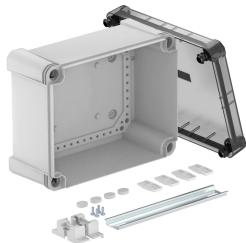
Boîte de dérivation avec rail DIN profilé pour connecter des câbles et des conduites en intérieur et en extérieur.. Forme rectangulaire sans ouvertures. Convient pour le montage au mur / au plafond avec possibilité de fixation extérieure, de fixation intérieure ou de montage sur les dômes d'angle. Particulièrement résistant aux chocs avec IK09 Couvercle transparent avec fermeture rapide, plombable. Fabriqué à partir de matériaux sans halogène et résistant aux UV.
