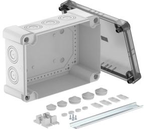
Boîte de dérivation avec rail DIN profilé pour connecter des câbles et des conduites en intérieur et en extérieur.. Forme rectangulaire avec entrées défonçables. Convient pour le montage au mur / au plafond avec possibilité de fixation extérieure, de fixation intérieure ou de montage sur les dômes d'angle. Particulièrement résistant aux chocs avec IK08. Couvercle transparent avec fermeture rapide, plombable. Fabriqué à partir de matériaux sans halogène et résistant aux UV.
